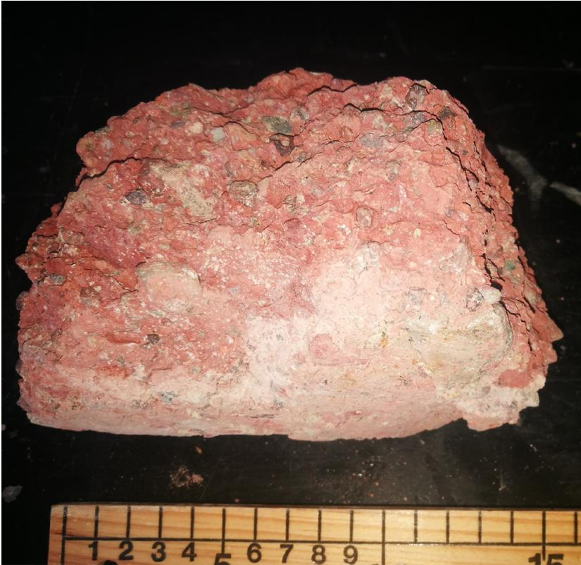
Figura 9. Muestra obtenida de los estabilizadores y hombros de la barrena correlacionada a una profundidad de 980 md.
