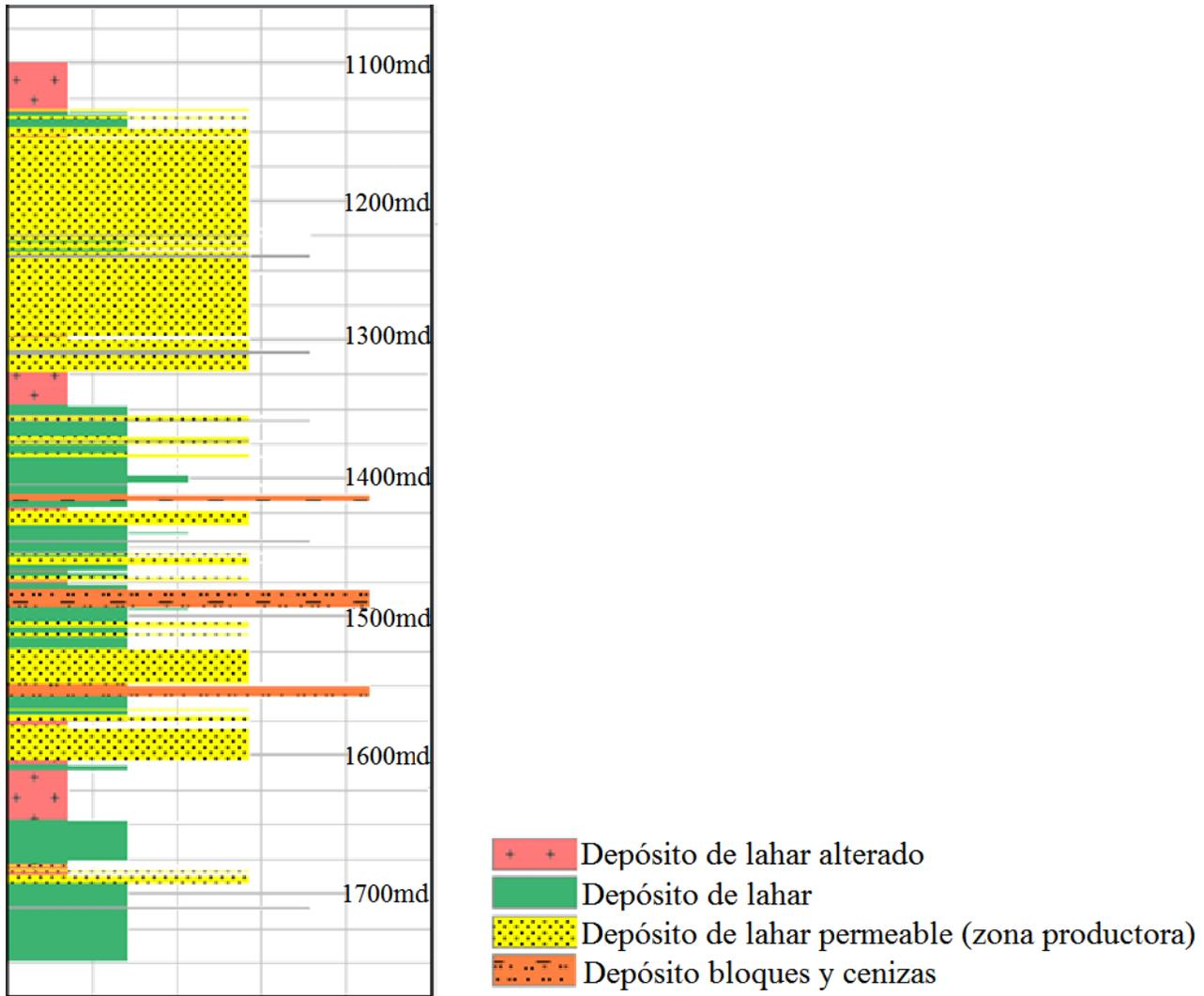
Figura 52. Columna generada a partir de los registros geofísicos para la segunda sección.
