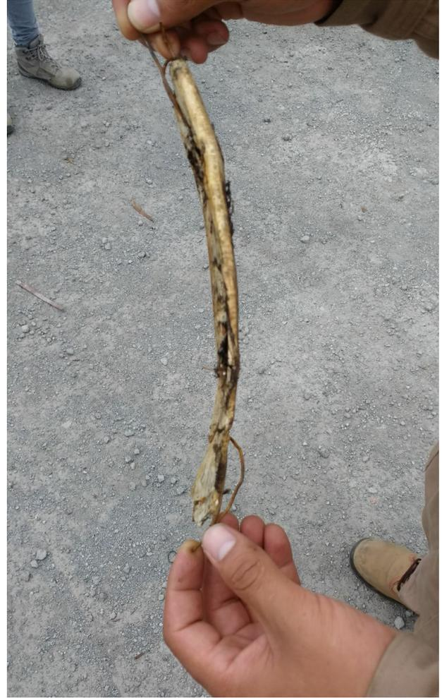
Figura 65. Imágenes del sensor destruido dentro del pozo por golpeteo entre la tubería de bombeo y la TR.
