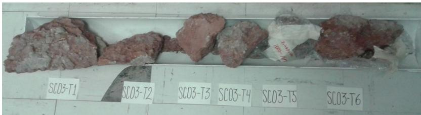
Figura 10. Muestras colectadas en los hombros de la barrena y estabilizadores seleccionados para su clasificación por tamizado.
