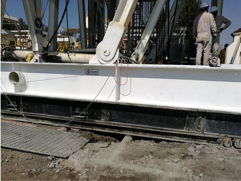
Figura 6. Oquedad por debajo de la plataforma del equipo de perforación.
