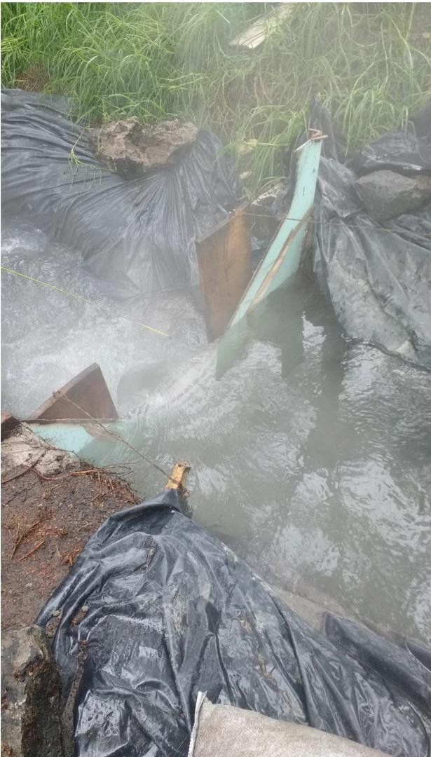
Figura 64. Imagen del vertedero instalado a la descarga.
