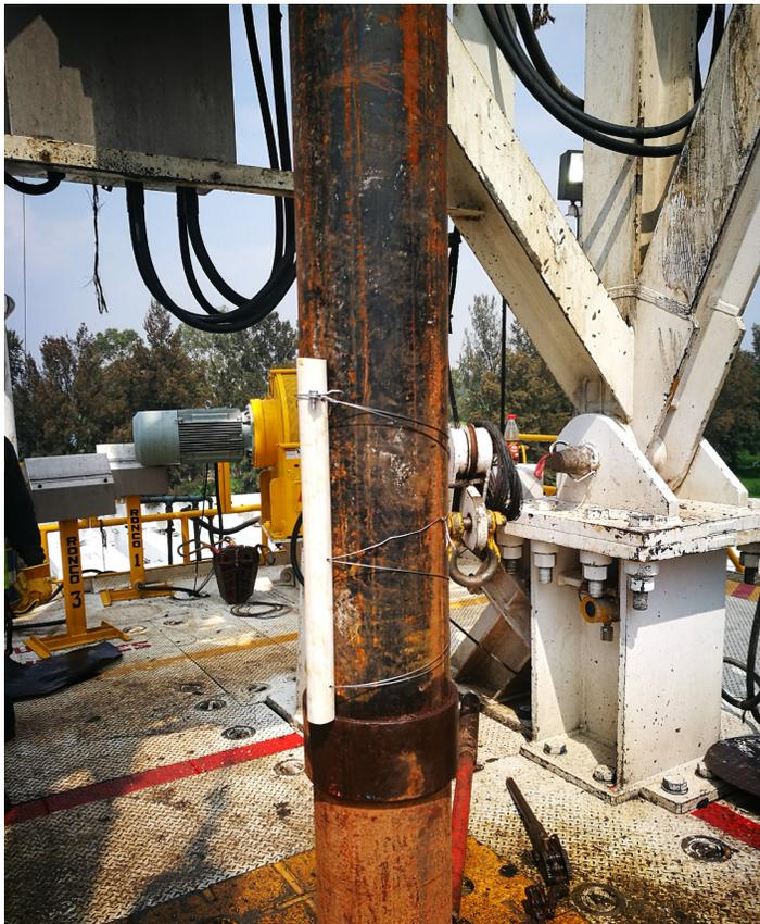
Figura 53. Instalación del DataLogger a un costado de la tubería de bombeo. b) Sensor instalado dentro de un tubo de protección a un costado de la tubería.
