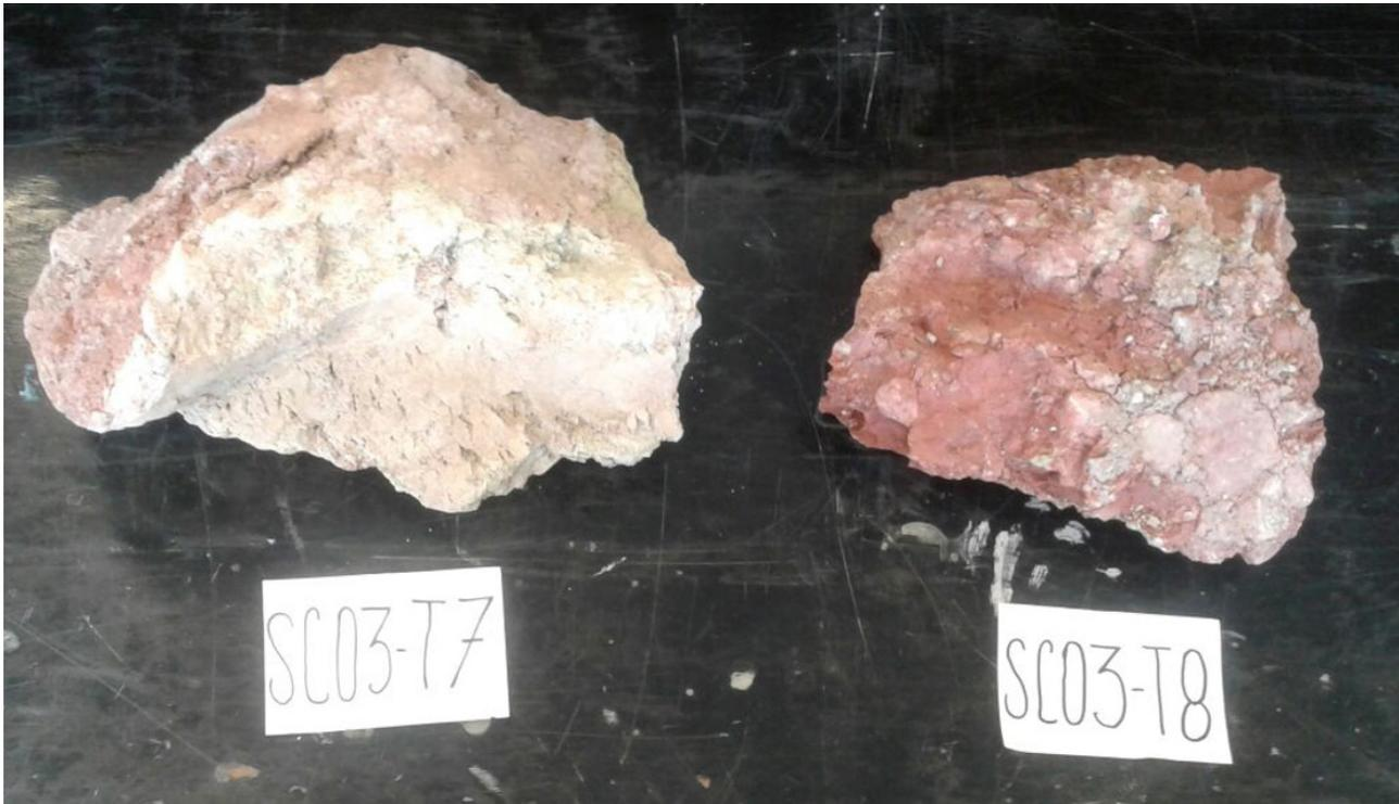
Figura 11. Muestras colectadas en los hombros de la barrena y estabilizadores seleccionados para su clasificación por tamizado.
