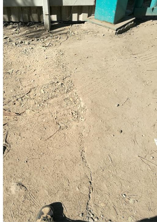
La perforación continuó hasta una profundidad de 35 m, tiempo en el que se observaron grietas y una pequeña oquedad cerca del equipo de perforación (Figura 5).
