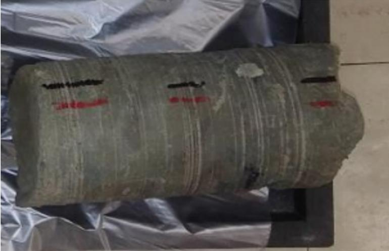
Figura 36. Muestra SCN1-1 entregada al INEEL sin rectificar.
