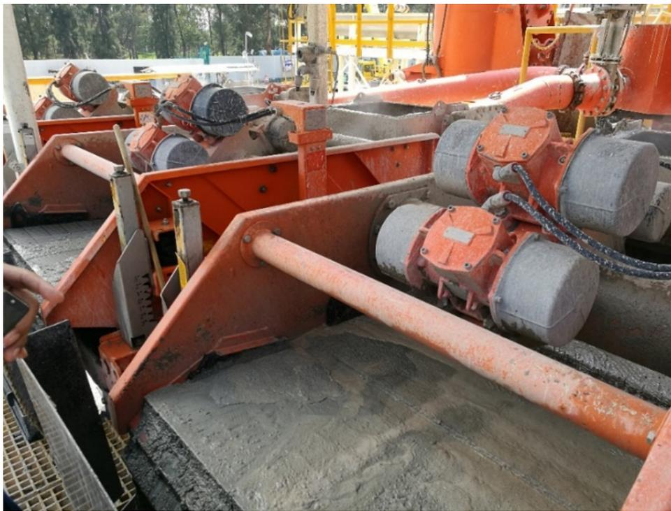
Figura 8. Material arcilloso observado en las *temblorinas* del equipo de perforación correlacionada con la formación Taxhimay.
