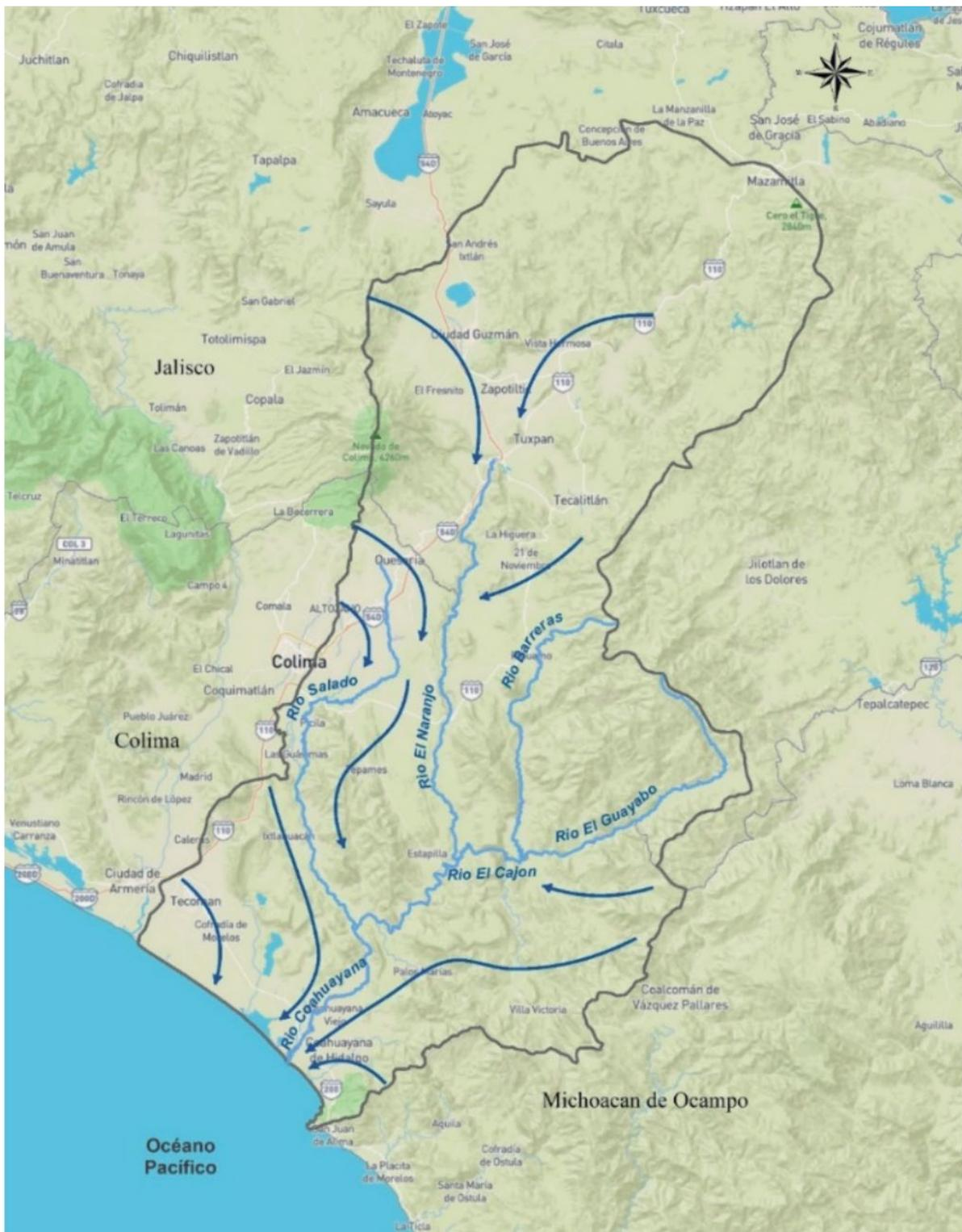
Figura 7.268. Esquema del flujo de agua subterránea del Sistema Coahuayana (elaborado con base en las redes de flujo obtenidas de CONAGUA, IMTA, UNAM).
