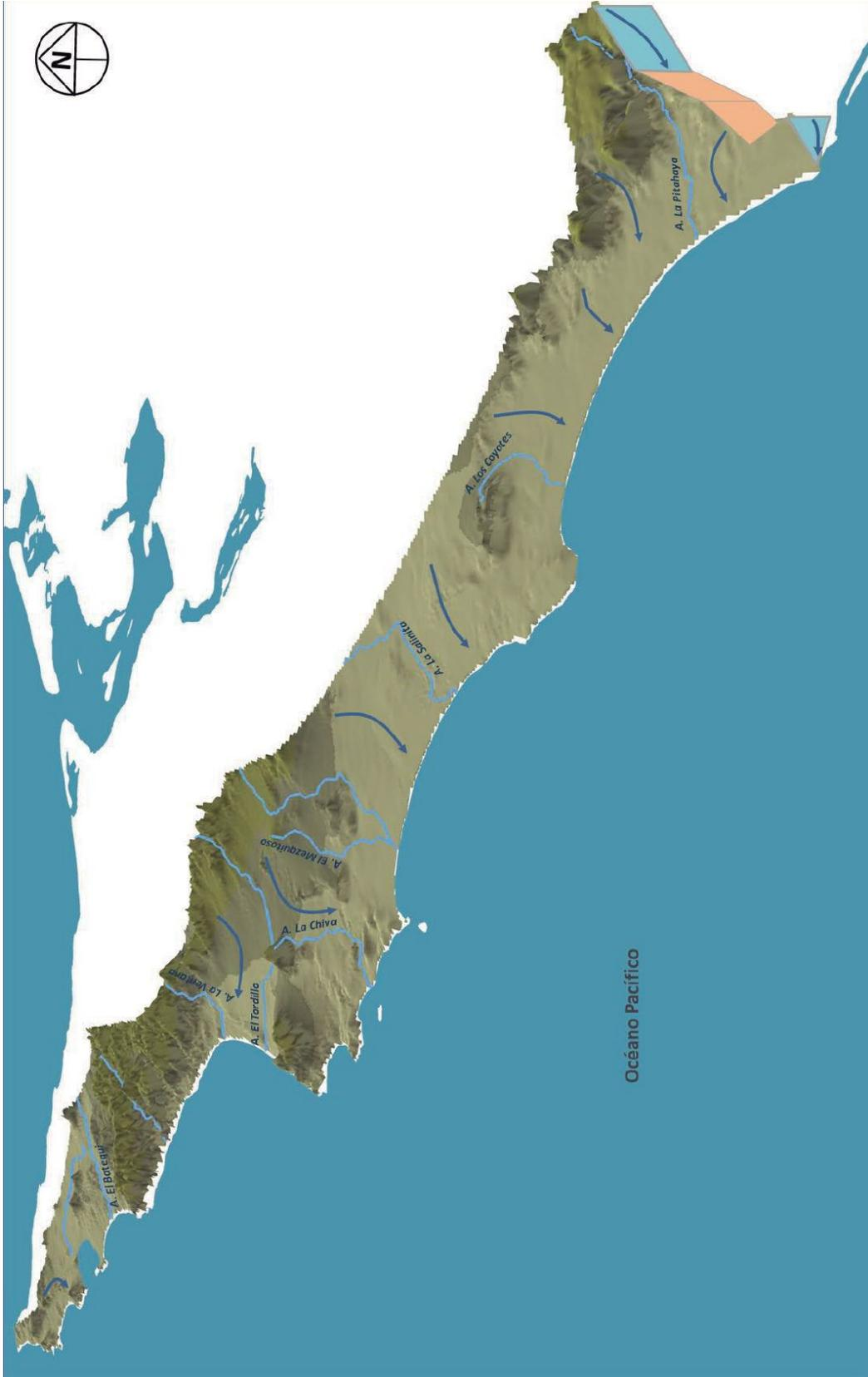
Figura 7.173. Bloque 3D y esquema del flujo de agua subterránea del Sistema Punta Prieta (elaborado con base en las redes de flujo obtenidas de CONAGUA, IMTA, UNAM).
