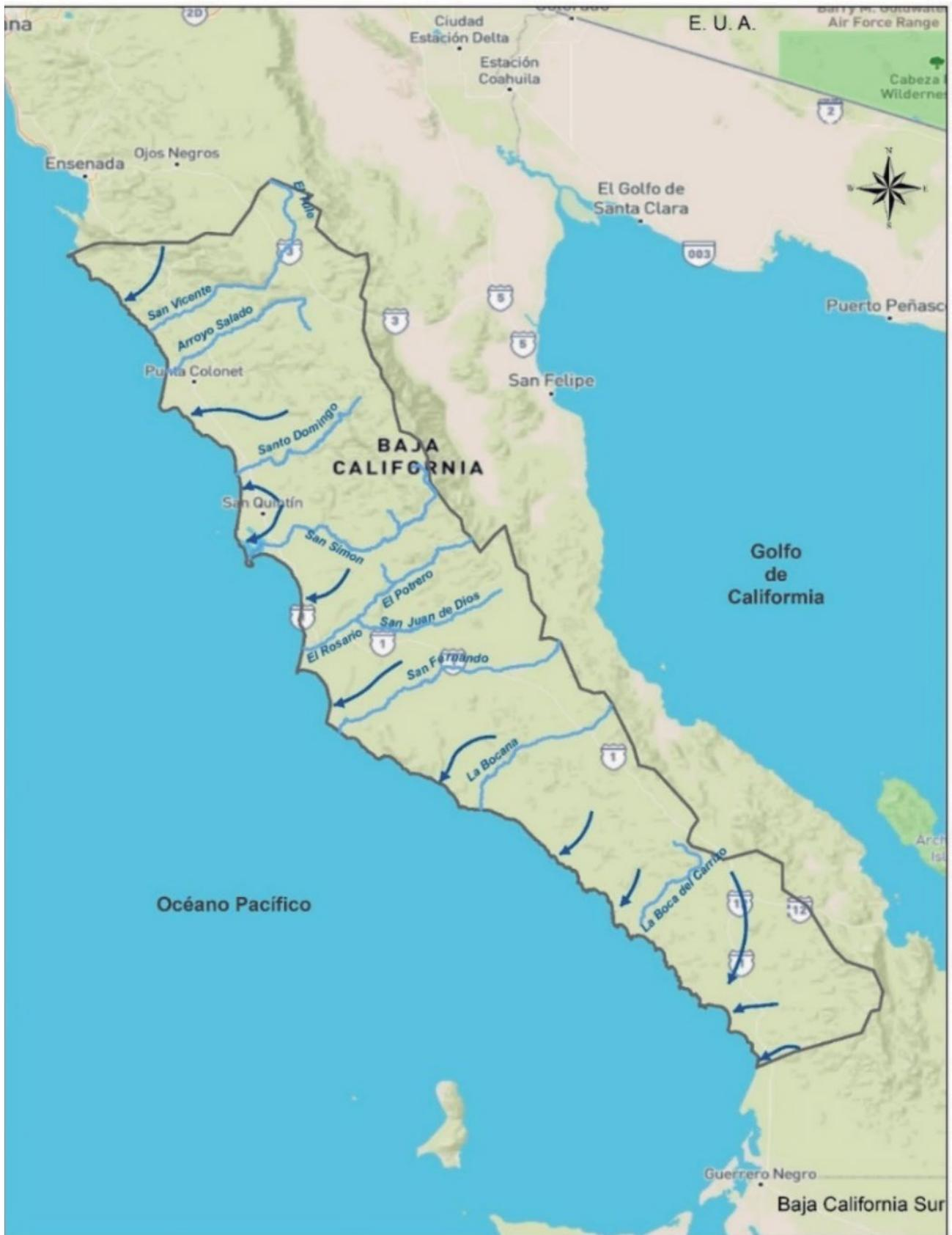
Figura 7.207. Esquema del flujo de agua subterránea del Sistema Camalú (elaborado con base en las redes de flujo obtenidas de CONAGUA, IMTA, UNAM).
