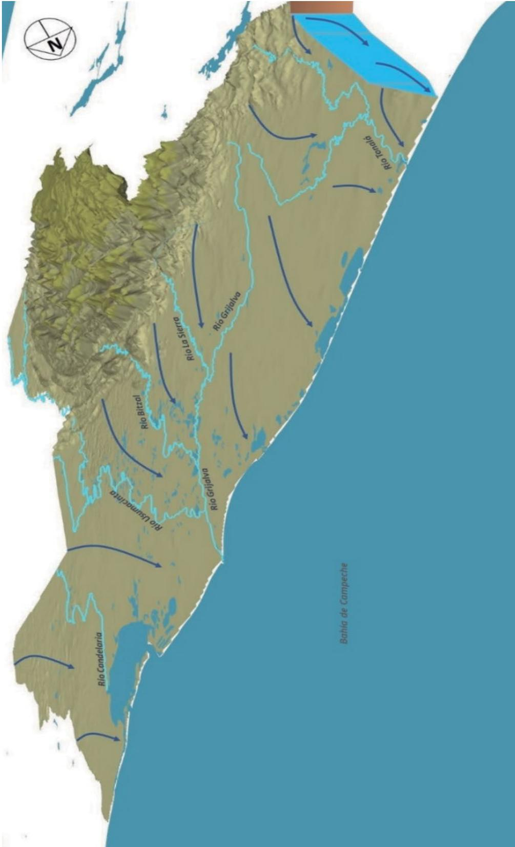
Figura 7.148. Bloque 3D y esquema del flujo de agua subterránea del Sistema Pinotepa (elaborado con base en las redes de flujo obtenidas de CONAGUA, IMTA, UNAM).
