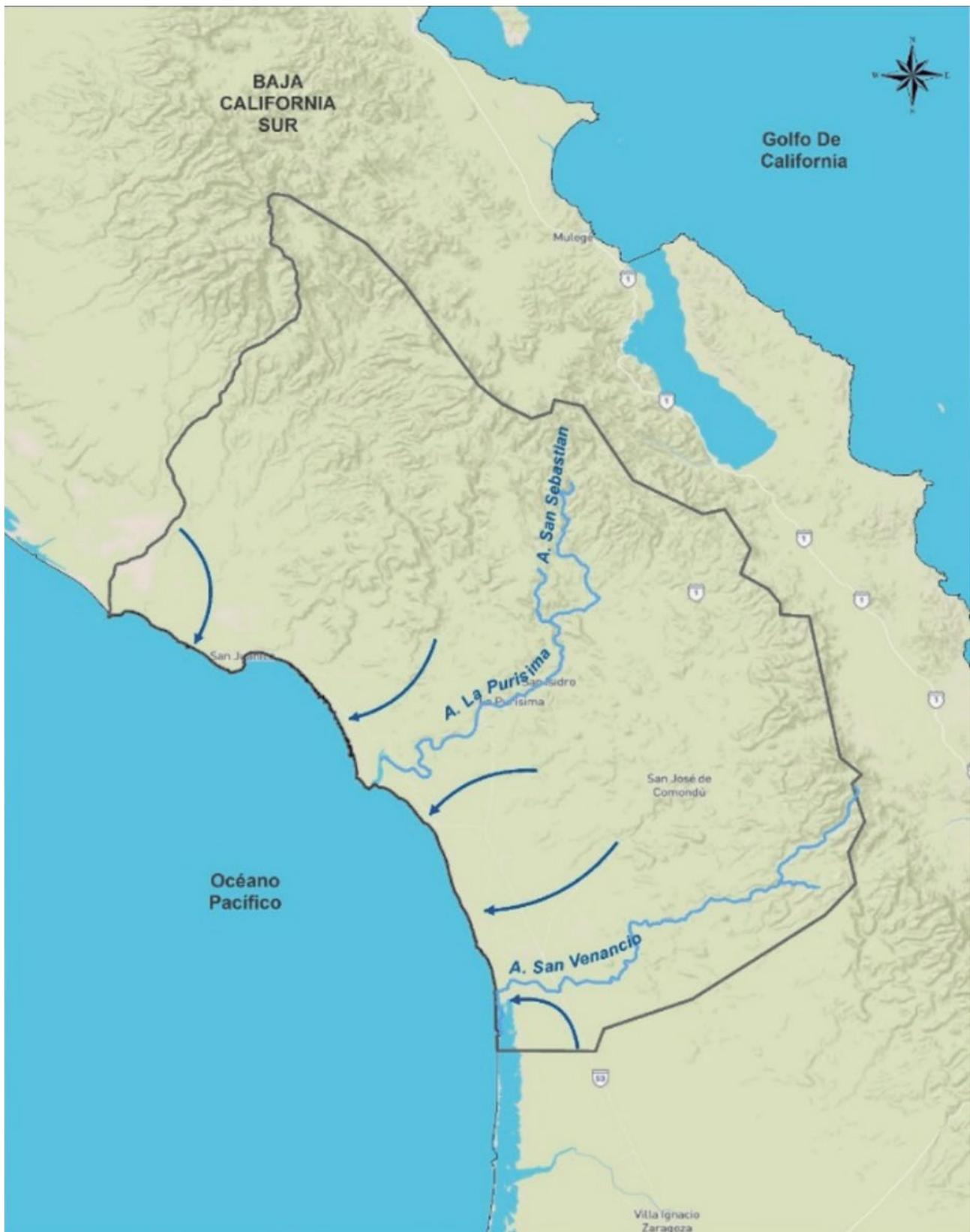
Figura 7.227. Esquema del flujo de agua subterránea del Sistema Barrancas (elaborado con base en las redes de flujo obtenidas de CONAGUA, IMTA, UNAM).
