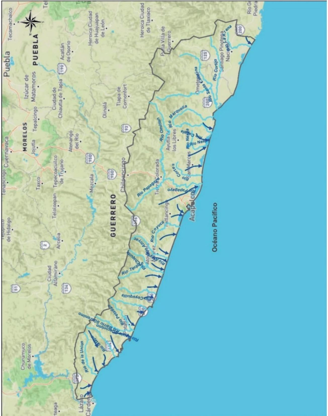
Figura 7.132. Esquema del flujo de agua subterránea del Sistema Cuajinicuilapa (elaborado con base en las redes de flujo obtenidas de CONAGUA, IMTA, UNAM).
