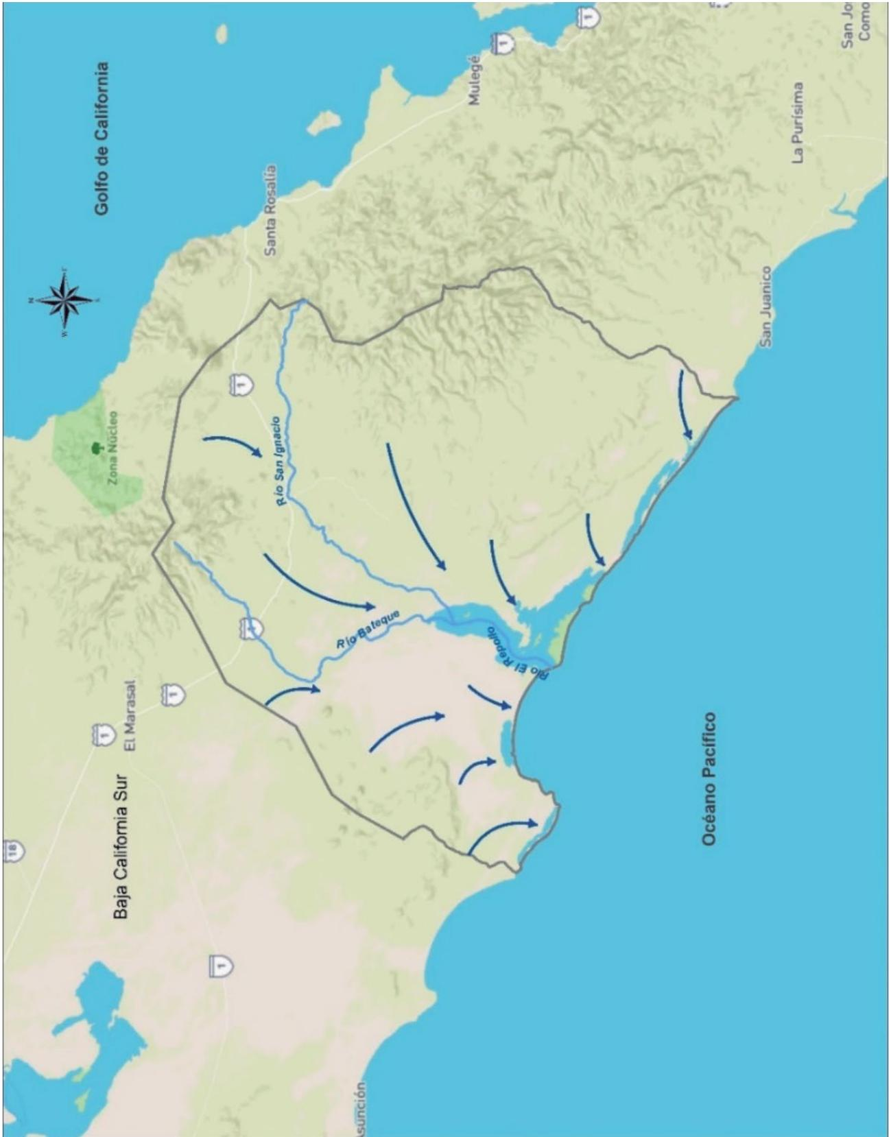
Figura 7.177. Esquema del flujo de agua subterránea del Sistema Querante (elaborado con base en las redes de flujo obtenidas de CONAGUA, IMTA, UNAM).
