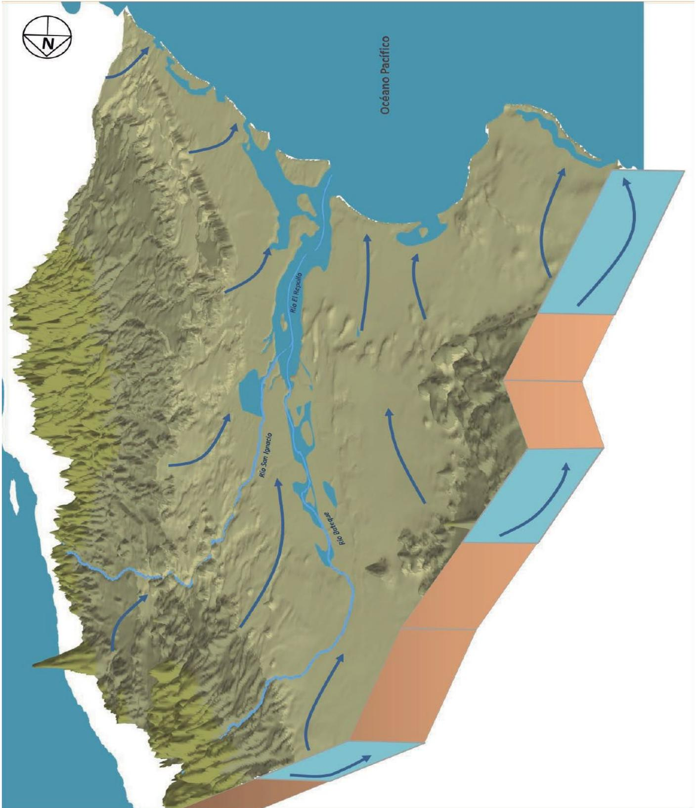
Figura 7.178. Bloque 3D y esquema del flujo de agua subterránea del Sistema Querante (elaborado con base en las redes de flujo obtenidas de CONAGUA, IMTA, UNAM).
