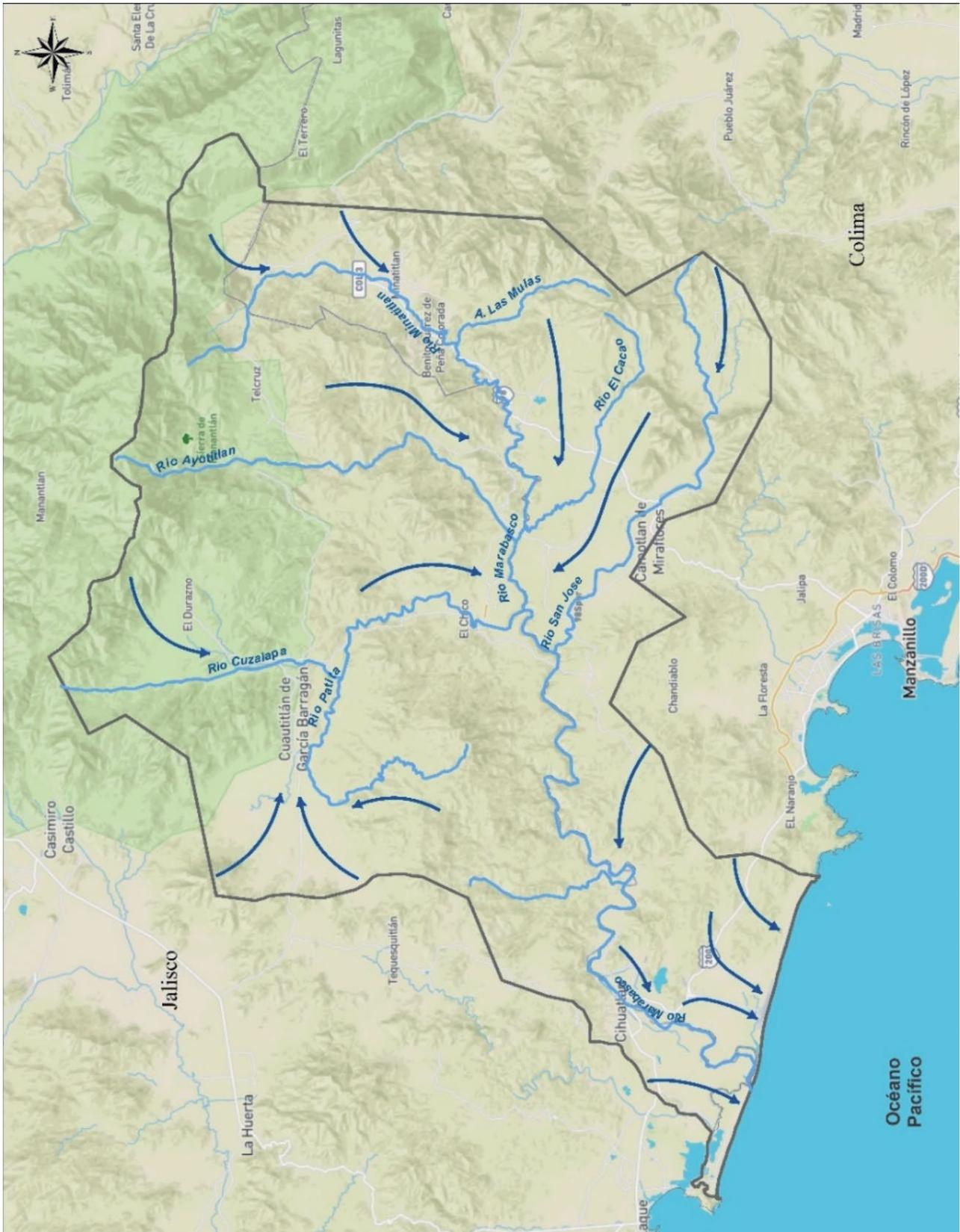
Figura 7.303. Esquema del flujo de agua subterránea del Sistema Cihuatlán (elaborado con base en las redes de flujo obtenidas de CONAGUA, IMTA, UNAM).
