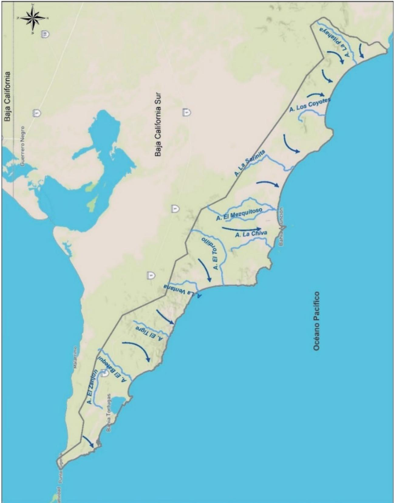
Figura 7.172. Esquema del flujo de agua subterránea del Sistema Punta Prieta (elaborado con base en las redes de flujo obtenidas de CONAGUA, IMTA, UNAM).
