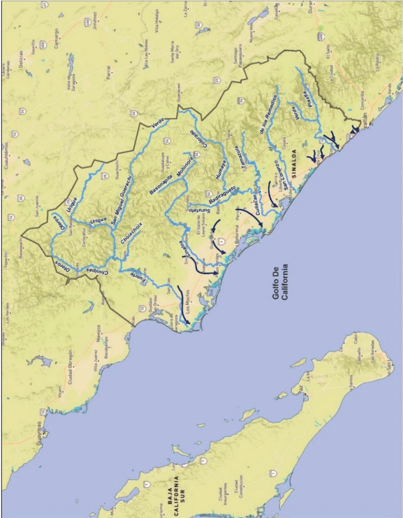
Figura 7.29. Esquema del flujo de agua subterránea del Sistema Sinaloa (elaborado con base en las redes de flujo obtenidas de CONAGUA, IMTA, UNAM).
