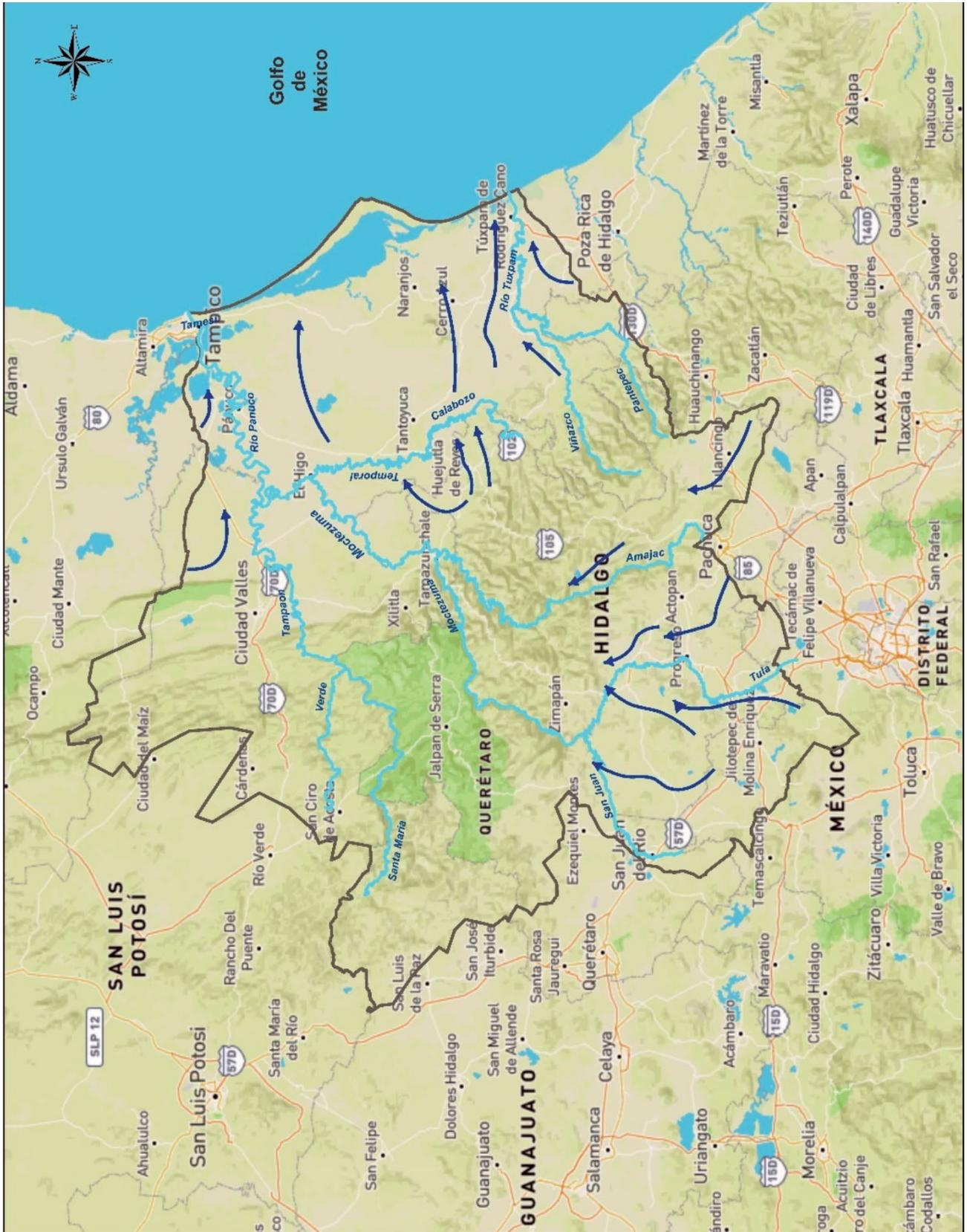
Figura 7.107. Esquema del flujo de agua subterránea del Sistema Tuxpan (elaborado con base en las redes de flujo obtenidas de CONAGUA, IMTA, UNAM).
