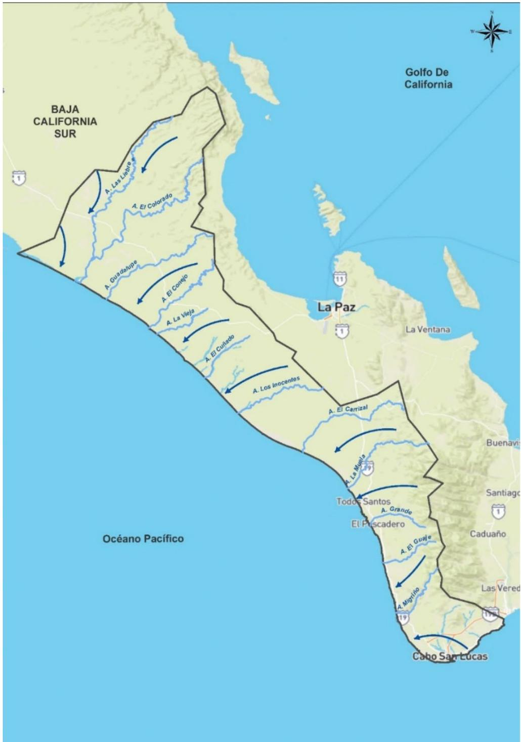
Figura 7.238. Esquema del flujo de agua subterránea del Sistema La Tinaja (elaborado con base en las redes de flujo obtenidas de CONAGUA, IMTA, UNAM).
