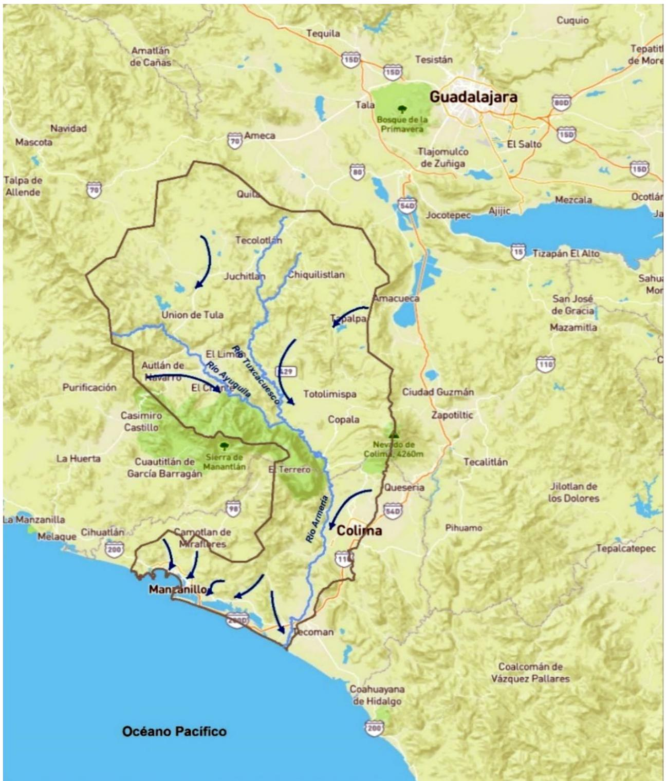
Figura 7.24. Esquema del flujo de agua subterránea del Sistema Tecomán (elaborado con base en las redes de flujo obtenidas de CONAGUA, IMTA, UNAM).
