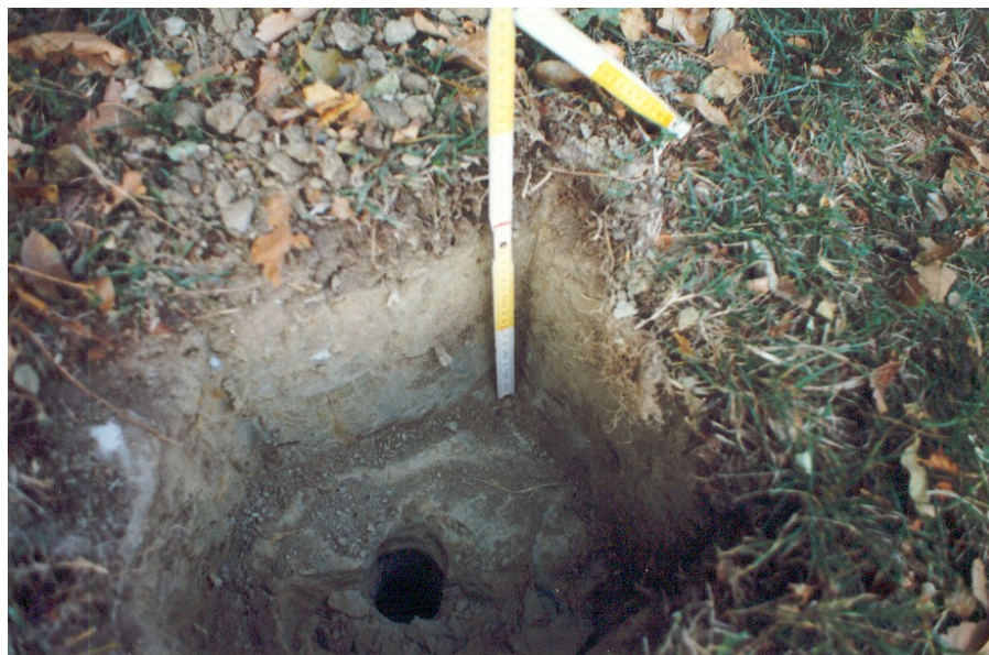
Figura 5.4.2.2.1. Pozo para medir conductividad hidráulica
