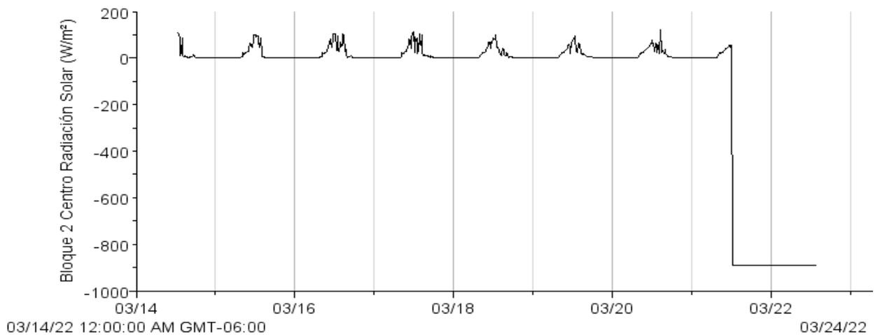
NOTA: Se registró falla en el sensor de radiación solar
