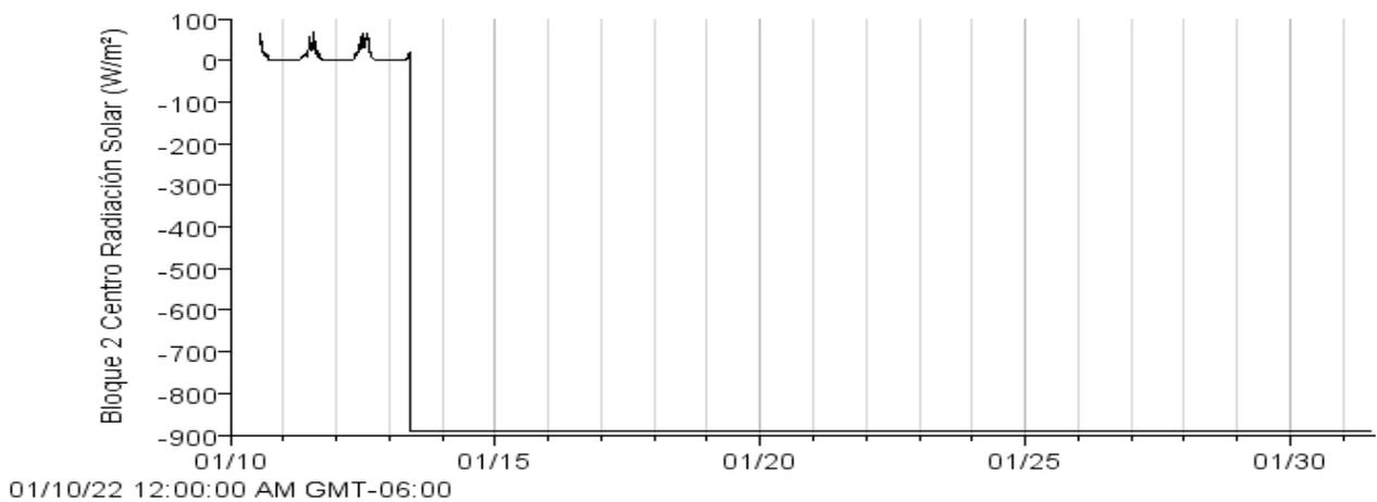
NOTA: Se registró falla en el sensor de radiación solar
