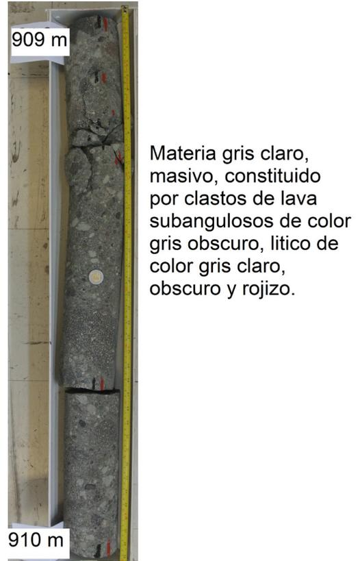
Figura A5.15. Descripción del núcleo N2-AO2B entre los 909 y 910 m.
