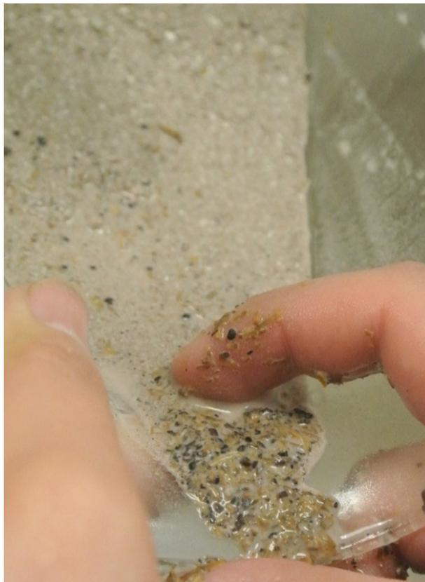
Figura A4.5. Mediante el lavado de la muestra es posible retirar la presencia de lodo de perforación, así como la cáscara de nuez y arroz.
