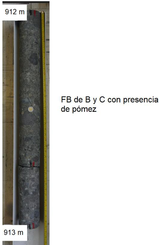
Figura A5.18. Descripción del núcleo N2-AO2B entre los 912 y 913 m.
