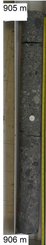
Material gris claro, masivo, constituido por clastos de lava y en menor cantidad pómez. <10% de pómez. Lítico de textura porfídica con fenocristales de Plg, Px y epidota. Composición andesítica. Clastos subredondeados y pómez redondeada. Flujo Piroclástico de Bloques y cenizas con poca pómez.
