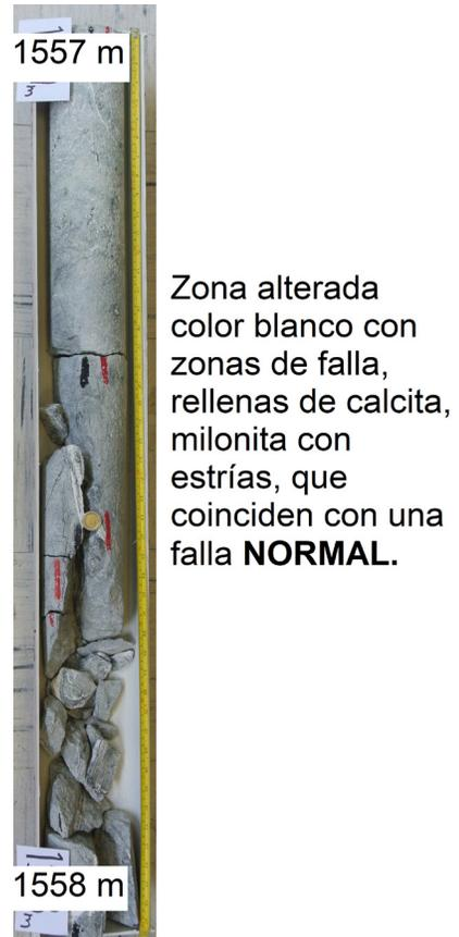
Figura A5.35. Descripción del núcleo N2-AO2C entre los 1557 y 1558 m.
