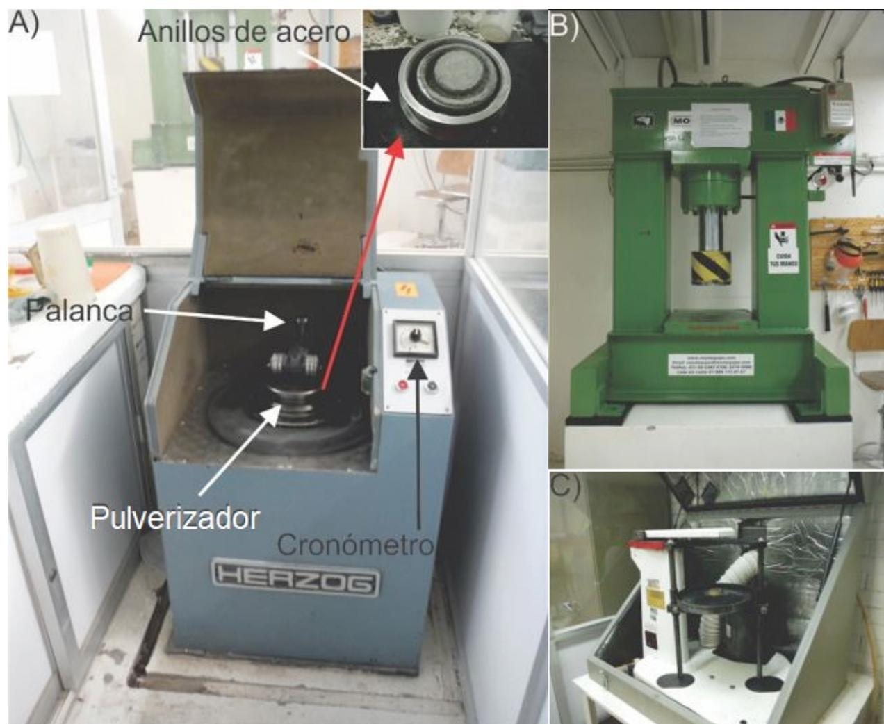
Figura 21. Fotografías del Taller de Molienda en donde se llevó a cabo el pulverizado de las muestras para los análisis químicos. A) Molino vibratorio Herzog H100 y sus componentes; B) Prensa modelo LAB-50TON-5HPM; C) Máquina vibratoria RO-TAP modelo RX-29.
