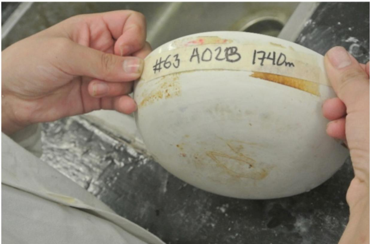
Figura A4.7. Antes de colocar la muestra ya lavada en el mortero, éste es etiquetado con los datos principales para llevar un control de secado.
