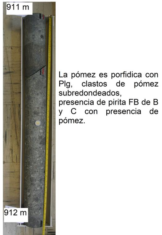
Figura A5.17. Descripción del núcleo N2-AO2B entre los 911 y 912 m.
