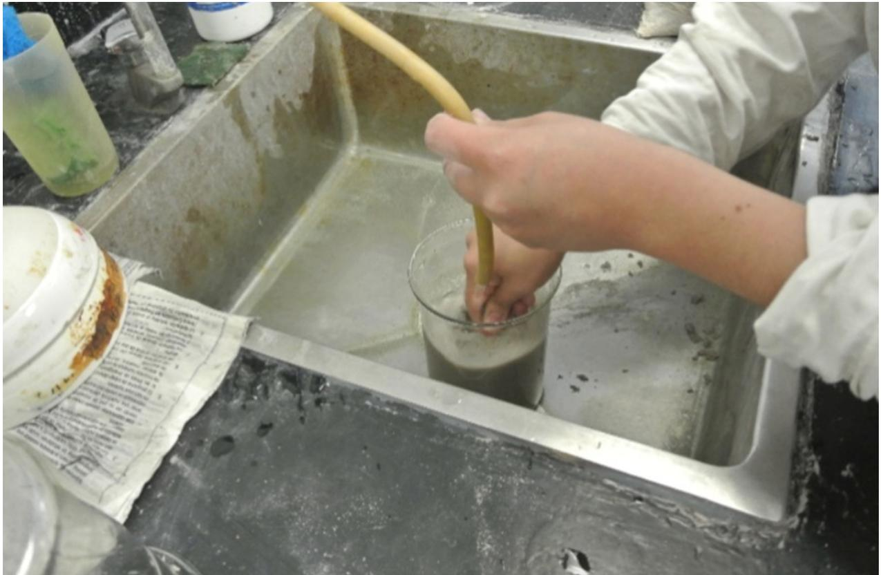
Figura A4.3. Se vierte agua en el vaso que contiene la muestra para ser lavada.
