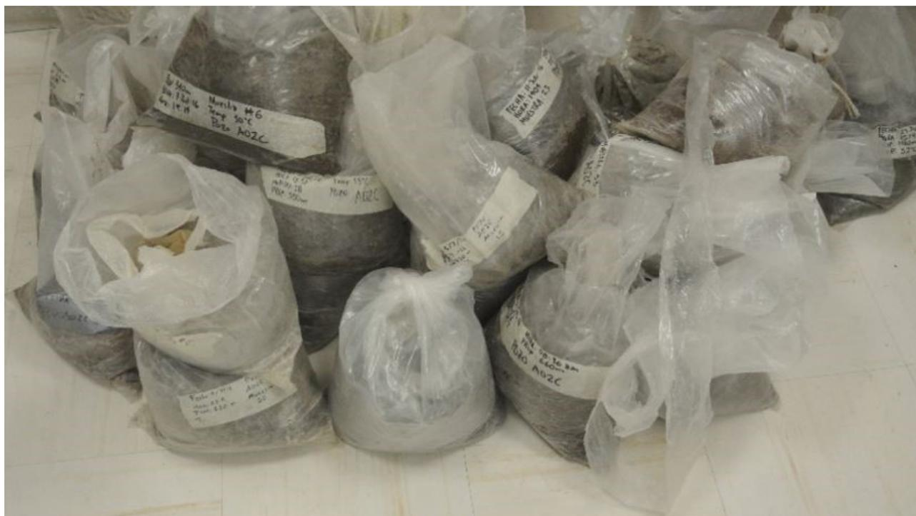
Figura 14. Muestras de recorte del pozo AO2B.
