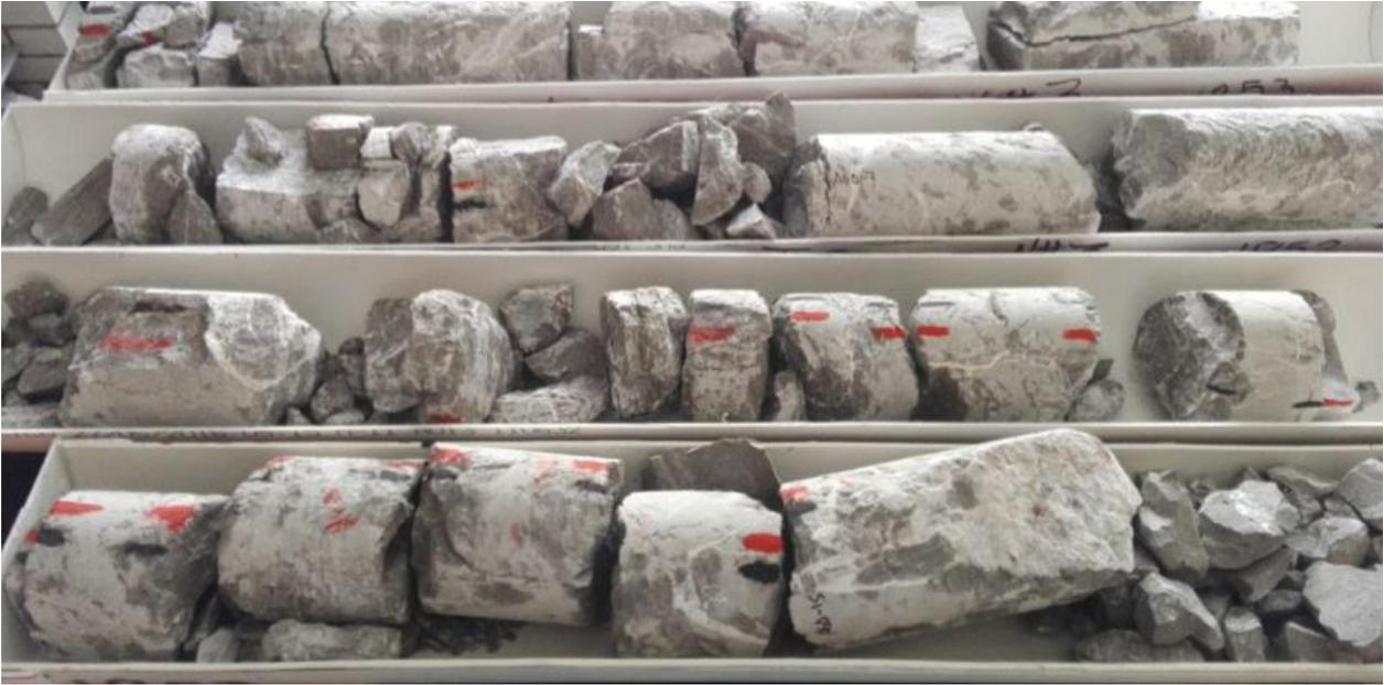
Figura 17. Ejemplo del Núcleo N3-AO2B después de ser extraído y sometido a limpieza.
