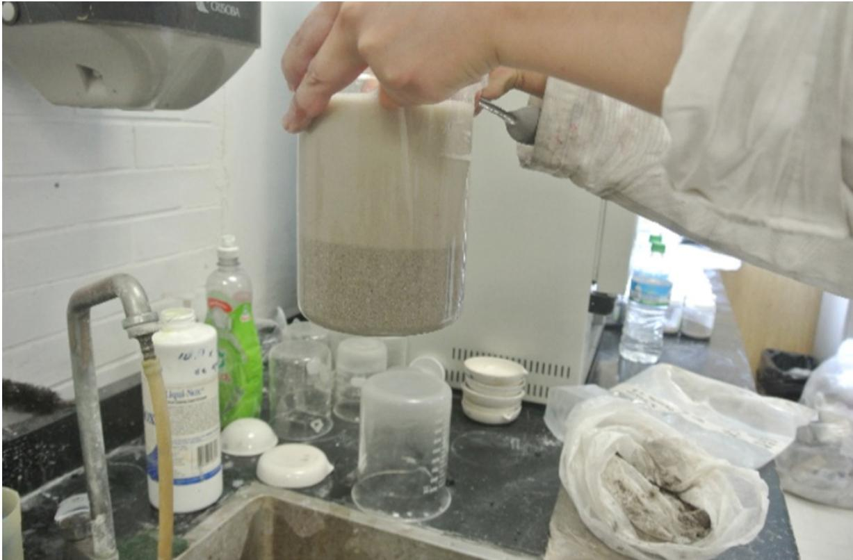
Figura A4.4. Después de verter el agua, la muestra se mueve con ayuda de la cuchara. Posteriormente se espera a que el sedimento se asiente.
