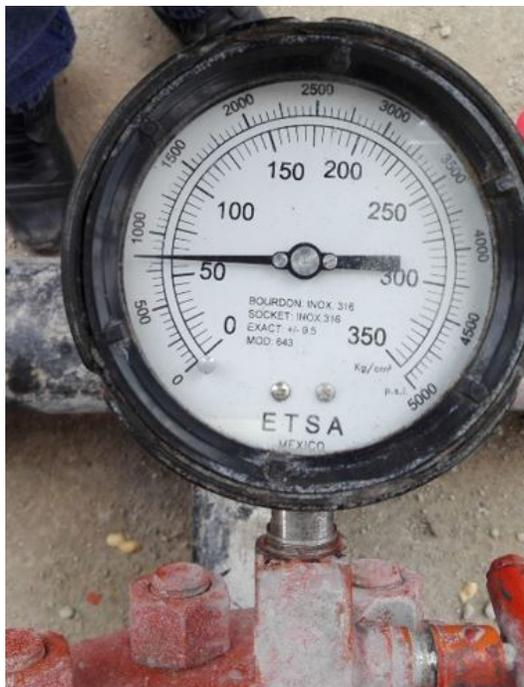
Figura 12. Presión de 800 PSI medida el 2 de septiembre en las válvulas de seguridad del pozo AO2B.
