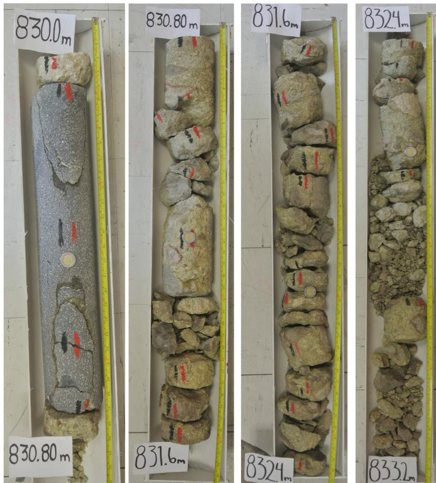
Figura A5.1. Secciones del núcleo N1-AO2B entre las profundidades 830 y 833.2 m.
