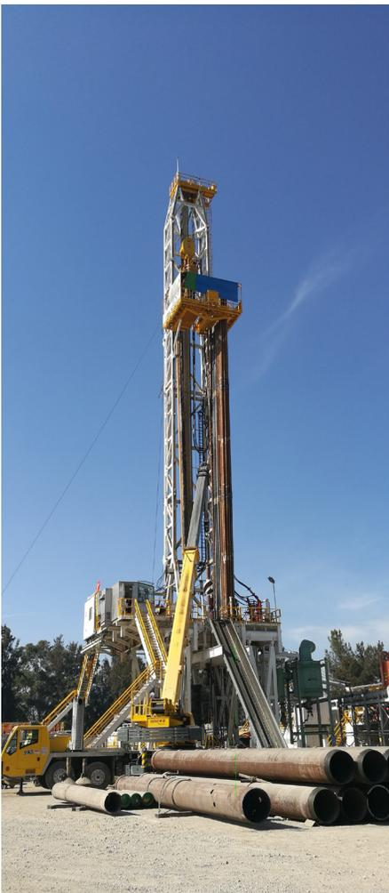
Análisis de la **estratigrafía** y las características **hidrogeológicas** de los estratos profundos que conforman el subsuelo de la cuenca de México a partir de la perforación de dos pozos profundos, uno a 2000 m y otro a 1570 m denominados Agrícola Oriental no. 2B y 2C
