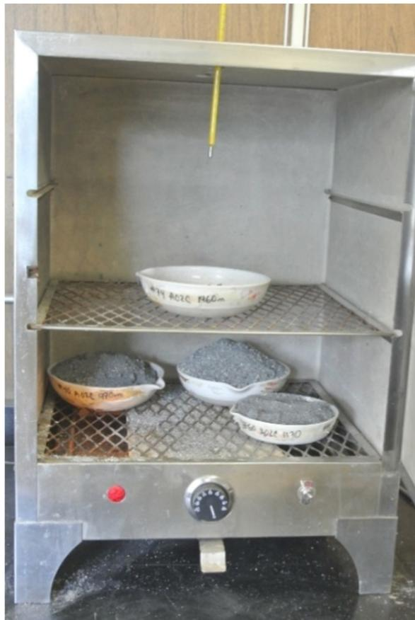
Figura A4.9. La muestra es colocada en el horno a 80°C por 18 horas aproximadamente para su secado.
