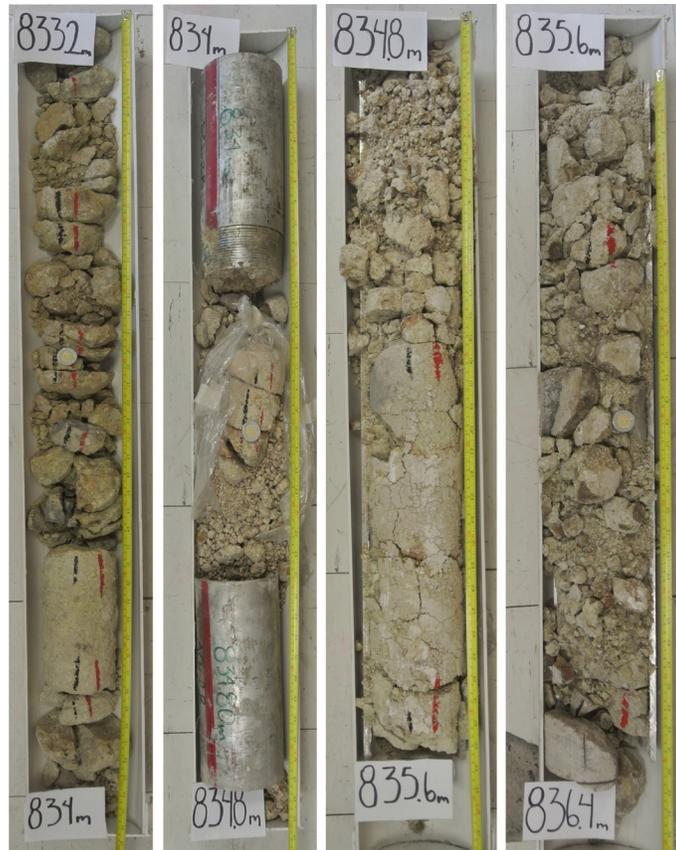
Figura A5.2. Secciones del núcleo N1-AO2B entre las profundidades 833.2 y 836.4 m.
