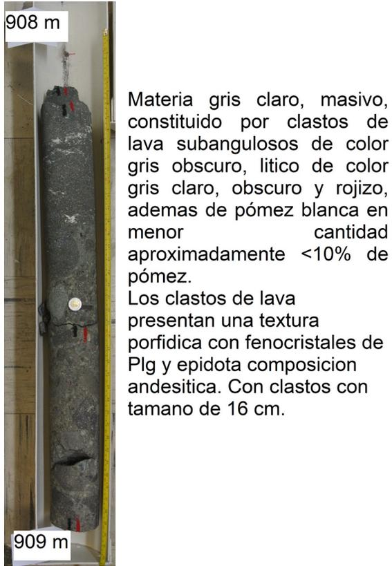
Figura A5.14. Descripción del núcleo N2-AO2B entre los 908 y 909 m.
