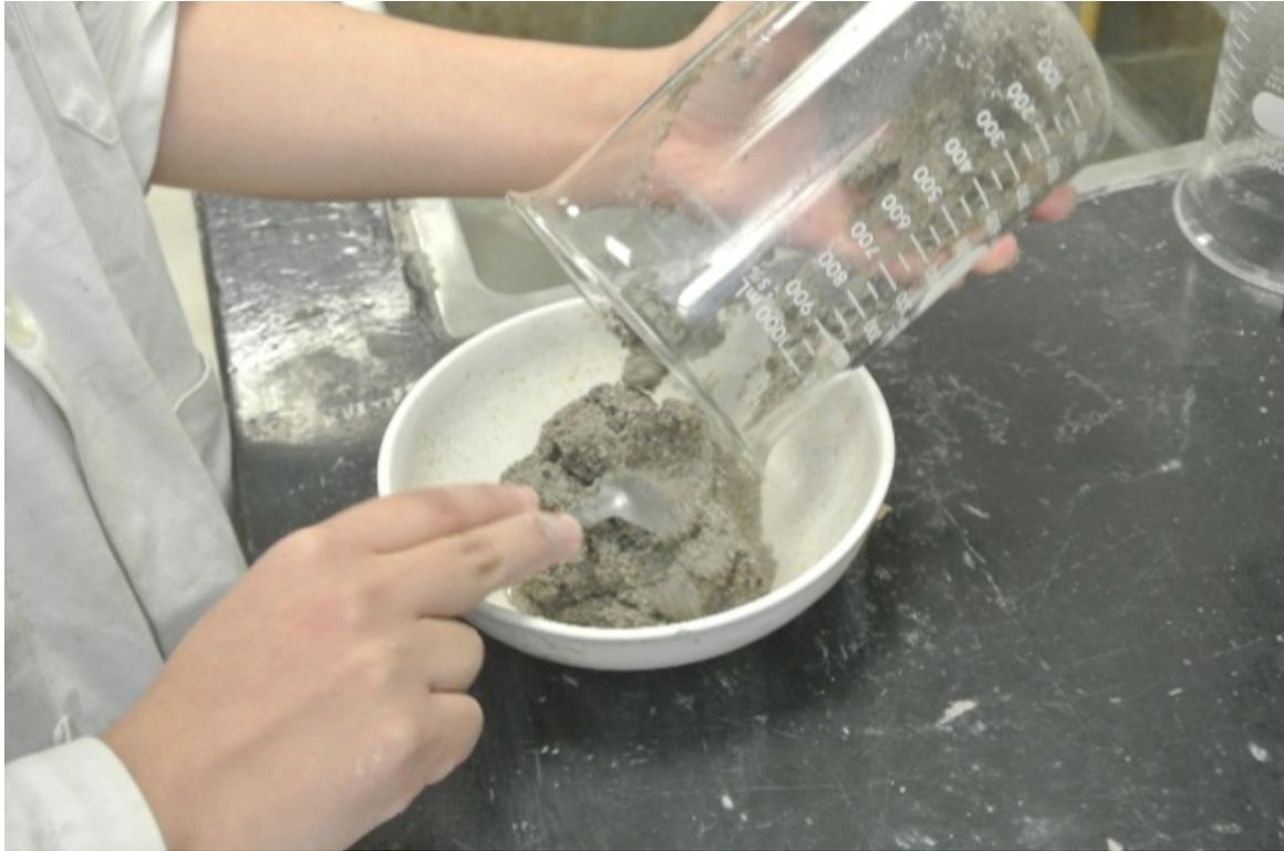
Figura A4.8. Al finalizar el lavado de la muestra ésta se vierte en un mortero para posteriormente meterla al horno.
