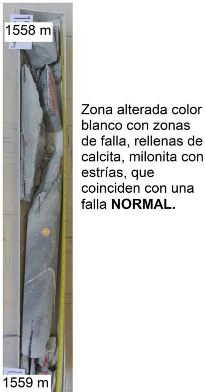
Figura A5.36. Descripción del núcleo N2-AO2C entre los 1558 y 1559 m.
